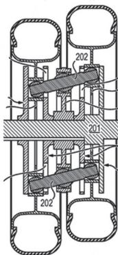
**Les roues du montage jumelé sont mobiles entre-elles. Lorsqu'une roue passe un obstacle, la seconde garde un contact avec le sol.**
