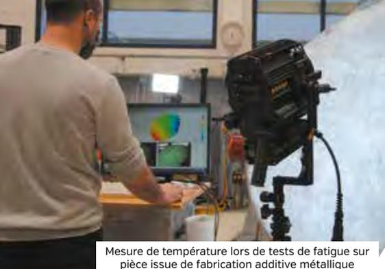
Mesure de température lors de tests de fatigue sur pièce issue de fabrication additive métallique
