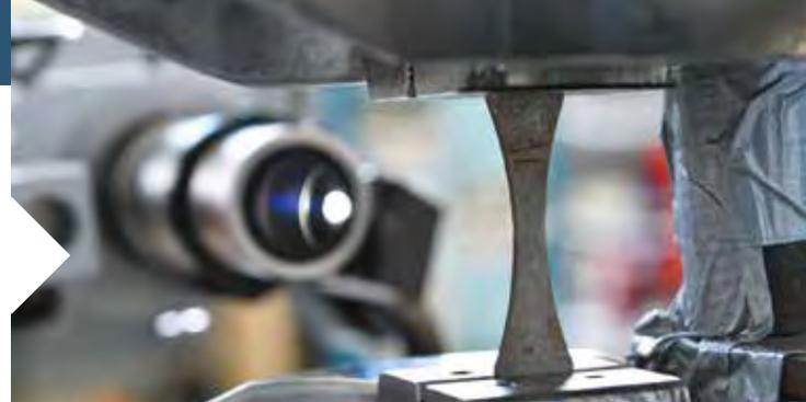
Début des travaux de recherche sur la fatigue à très grand nombre de cycle (VHCF). L'acquisition en 2021 d'une machine de fatigue gigacyclique très haute fréquence (20kHz) permet des mesures sous sollicitation à 100 milliards de cycles en seulement 14h. Cet équipement répond aux besoins expérimentaux de la chaire Self-Heating qui contribue à élargissement significativement le périmètre d'étude du laboratoire IRDL.
