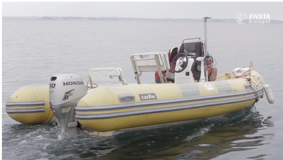
**FIGURE** – Boatbot, lors d'un essai en mer avec le sondeur de sédiments
