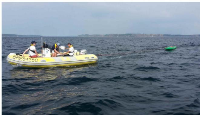
FIGURE – Boatbot, tractant un canoë tractant un magnétomètre, lors de la campagne de recherche de la *Cordelière* 2018
