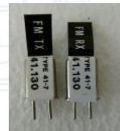
Exemples de quartz FM 41 MHz, un pour l'émetteur (TX) et l'autre pour le récepteur (RX). Une procédure de bind remplace maintenant l'utilisation des quartz pour associer un émetteur à un récepteur
