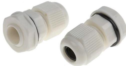
Attention au diamètre et la déformation du câble notamment quand on le plie, 1 câble par passe-câble pour être étanche, voir la norme d'étanchéité IPXX (e.g. IP68) ainsi que pression ou profondeur max, attention au matériau constituant le câble si une résine (qui doit coller dessus) est nécessaire pour garantir l'étanchéité (e.g. pour anciens penetrators Blue Robotics), etc.
