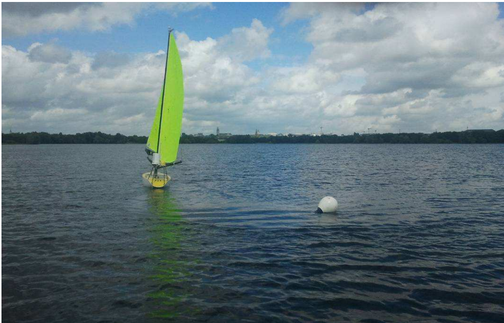
Figure 5 : VAIMOS tractant une bouée sur le Lac de Maine pour tester la robustesse de sa régulation
