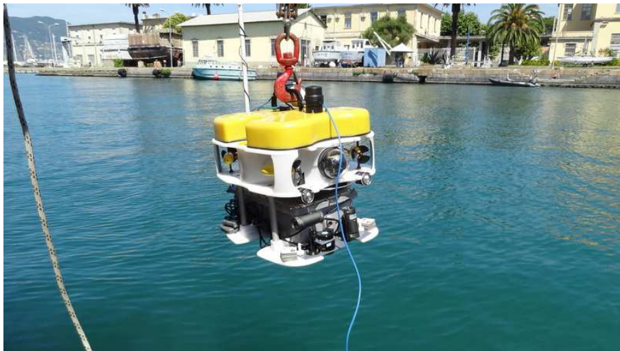
Figure 2 : Mise à l'eau du robot CISCREA modifié en 2013. 2 robots supplémentaires vont être préparés en 2014 en combinant les choix faits en 2012 et 2013, et avec de nouvelles batteries.
