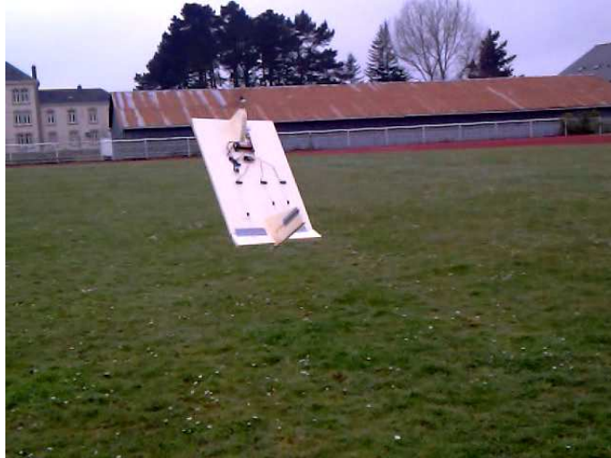
Figure 7 : Premiers tests avec un hydroplane téléguidé construit à l'école, engin capable de flotter, décoller sur l'eau, voler, amerrir, et décoller et atterrir sur terre dans certaines conditions.
