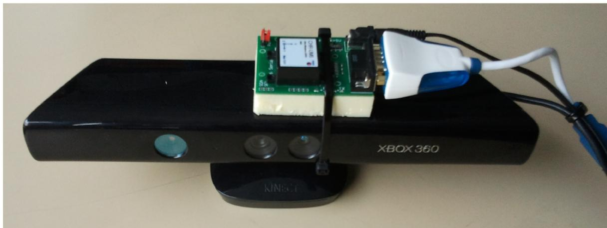
Figure 17 : Kinect montée avec une centrale inertielle
