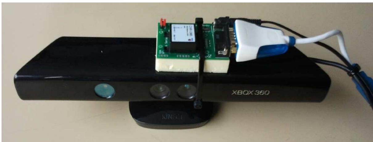
Figure 7 : Kinect montée avec une centrale inertielle
