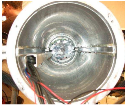
Figure 8: Rails à l'intérieur du tube de SAUC'ISSE
