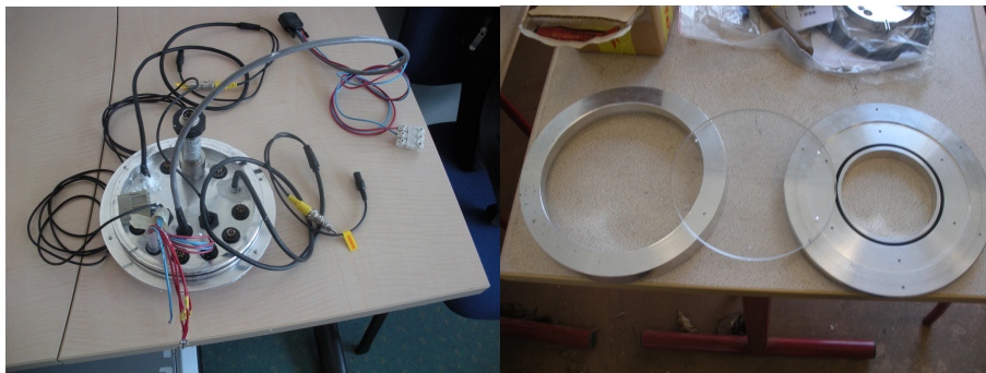
Figure 5: Tape arrière de SAUC'ISSE avec ses connecteurs (côté intérieur) et tape avant de SARDINE, avec un hublot
