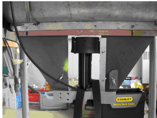
Figure 7: Propulseur vertical centré dans la quille
