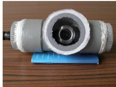
Pour obtenir la profondeur du sous-marin, nous utilisons un capteur de pression Keller PAA33X connecté au PC104 via un convertisseur RS485 vers USB. Ce capteur est fixé sur la tige arrière du sous-marin.
