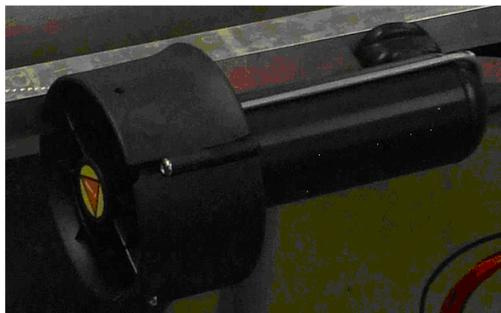
Pour contrôler la vitesse des propulseurs à partir de signaux PWM, nous utilisons des variateurs de modélisme Robbe Rokraft. Les signaux PWM sont générés par un boîtier d'interface Labjack UE9, connecté par USB au PC.
