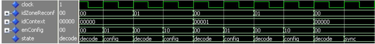
FIG. 7.15 – Chronogramme de simulation du multiplexage des configurations sur une matrice CGRA.
