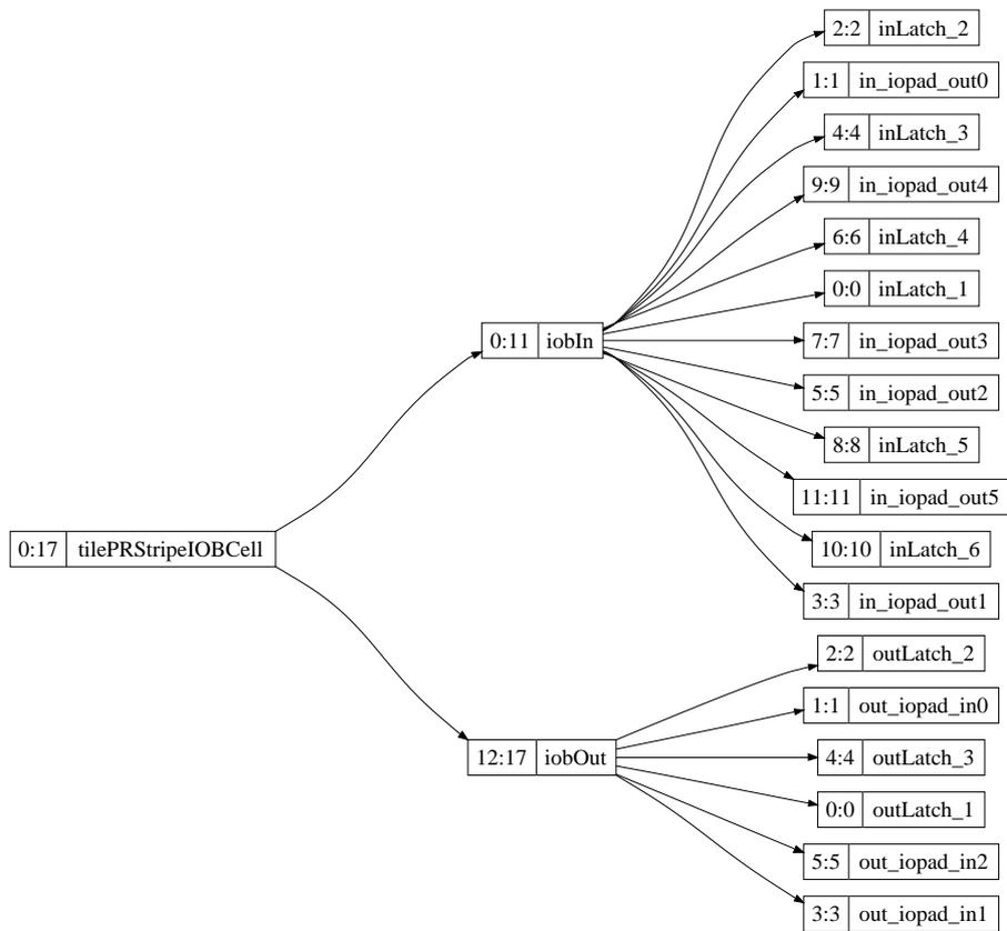
FIG. 7.7 – Répartition hiérarchique des bits de configuration pour une tuile IOB de l'architecture CGRA.
