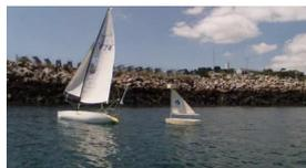
Deux robots voiliers de l' **ENSTA** Bretagne : à gauche, le Vaimos et à droite, un prototype de microvoilier.
