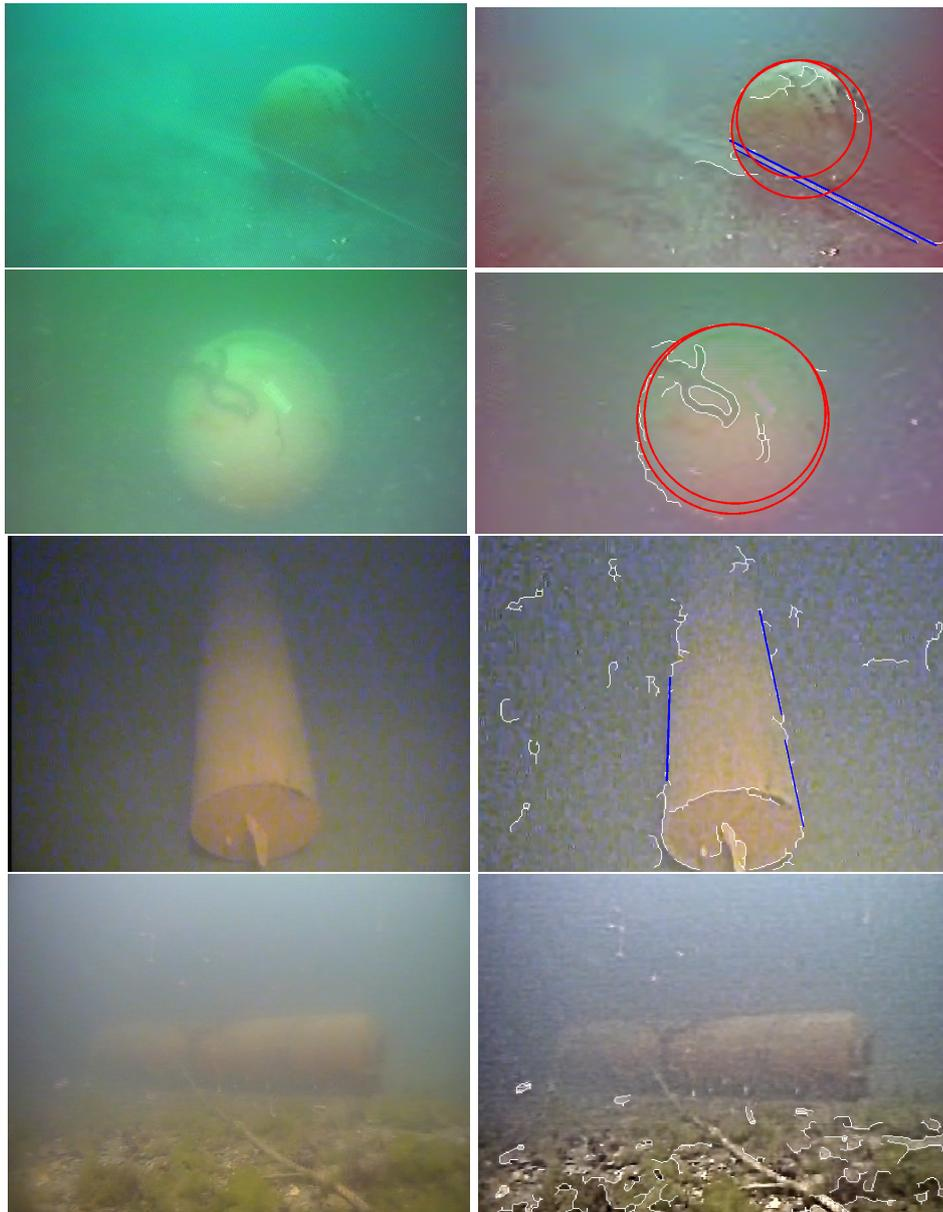
FIG. 7.6 – Exemples de détections d'objets (sphère, cylindre).
