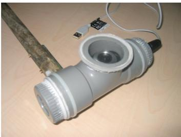
FIG. C.2 – Webcam haute résolution étanche.
