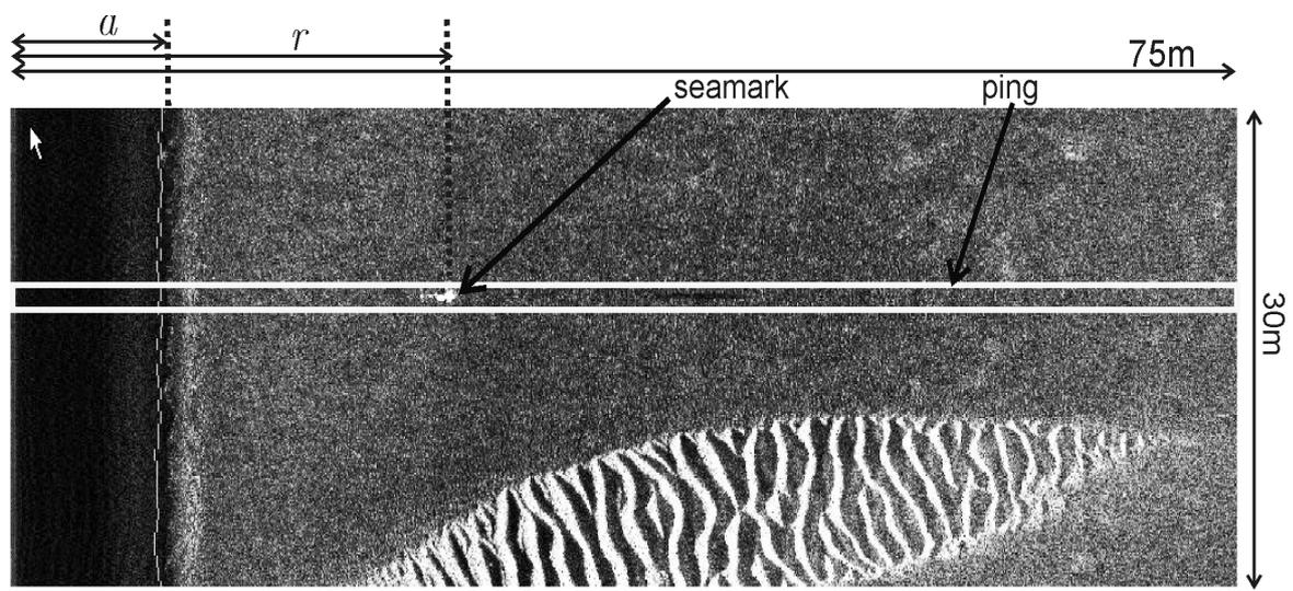
Détection d'une mine à l'aide de SonarPro
