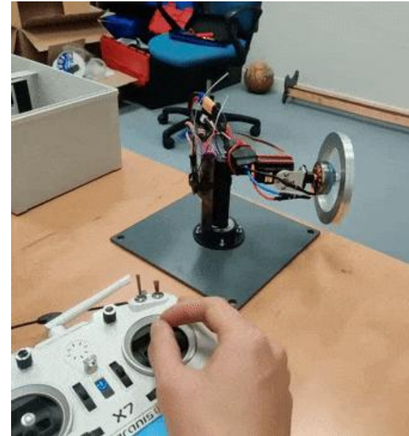
Test préliminaire de l'effet gyroscopique
