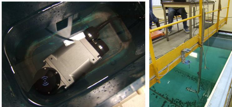
**Propulseurs.** Les quatre propulseurs étanches ont été montés et testés (voir photos). Nous sommes capables de commander les quatre moteurs à partir d'un exécutable tournant Linux et compilé sous gcc. Pour cela, nous avons utilisé un boîtier LabJack pour générer les quatre pwm. Ces quatre pwm alimentent quatre cartes de puissance de modélisme. Ces cartes sont reliées directement aux moteurs des propulseurs.
