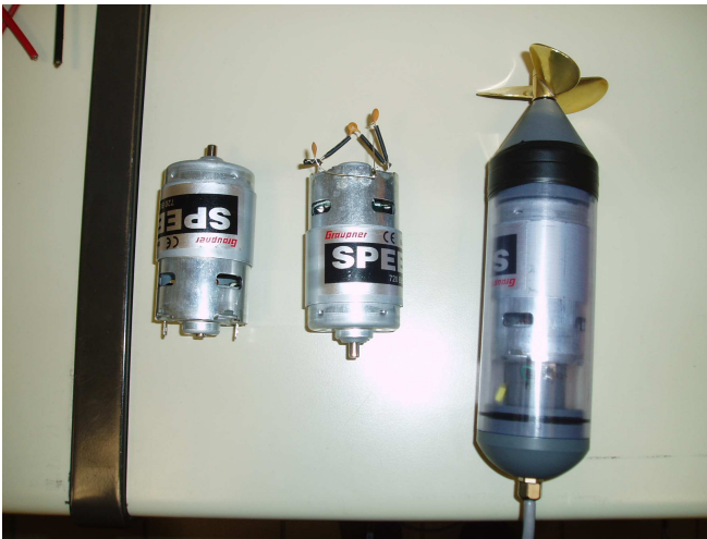
Figure 3 : Les propulseurs et leur boîtier étanche
