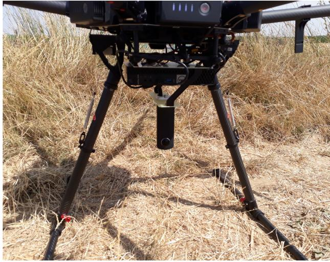
FIGURE 3.3 – Photo du support monté sur drone, avec Ricoh Theta S
