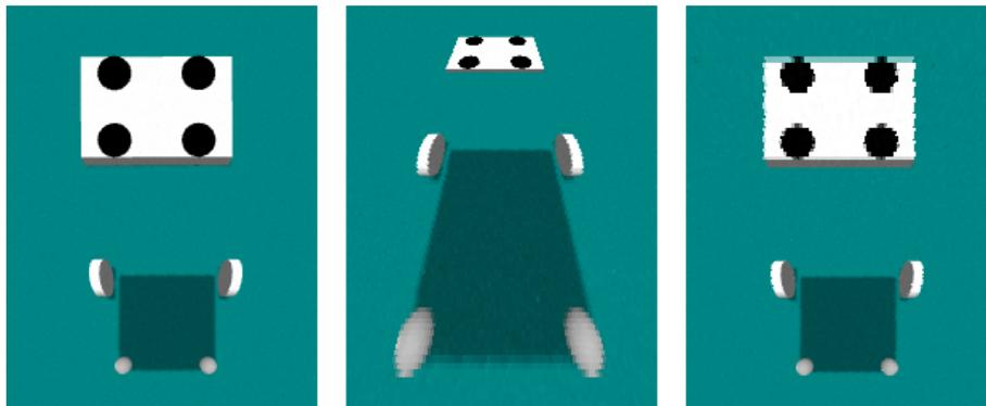
FIGURE 6.3 – Images perçue, déformée en tangage, et redressée
