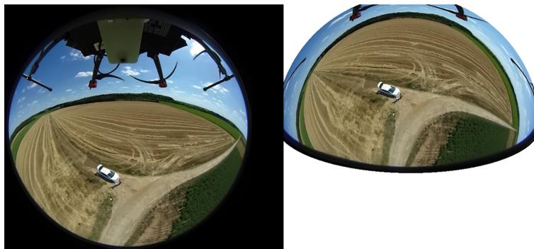
FIGURE 6.6 – Image initiale Fisheye (gauche) et image redressée (droite)
