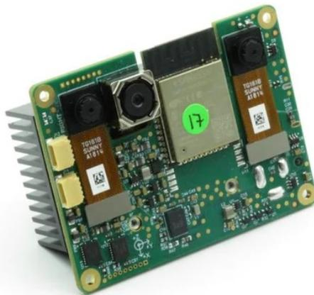
FIGURE 19 – Caméra Luxonis OAK-D-IoT-40. Taille : 60 mm de large, hauteur 45 mm, largeur 25 mm ; masse : 45,5 g sur [sa documentation technique](#).
