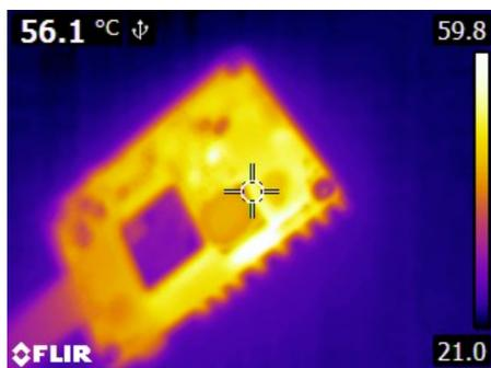
(c) Mesure d'échauffement au bout de 20 min
