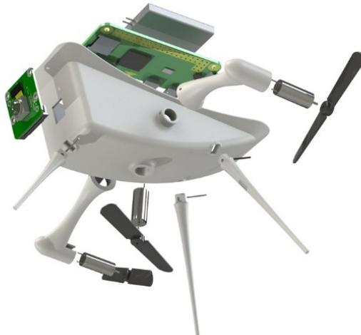
FIGURE 5 – Nacelle en impression 3D du minidirigeable [6]
