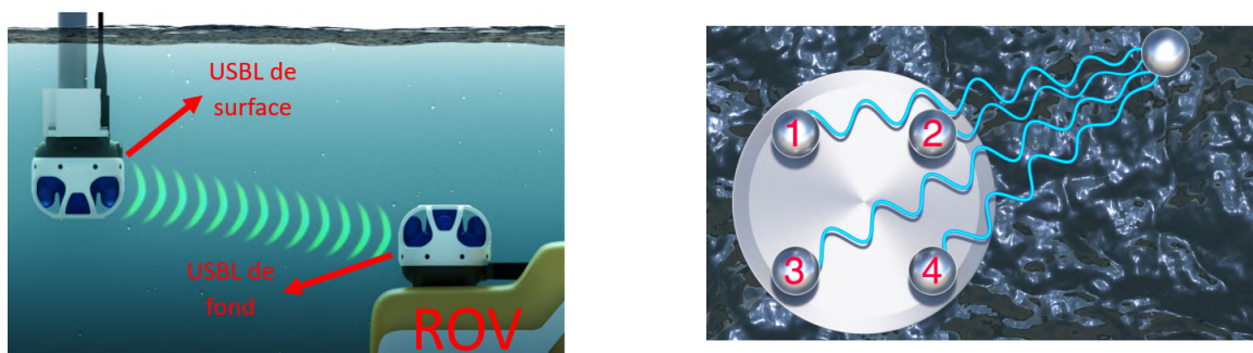
FIGURE 2.4 – Principe de fonctionnement des USBL
