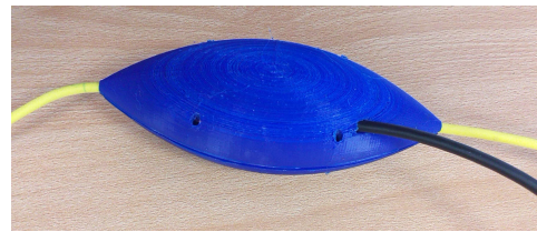
Figure 3.6: Modèle 3D imprimé au-dessus, demi-coque à gauche et coque entière fixée sur le câble à droite
