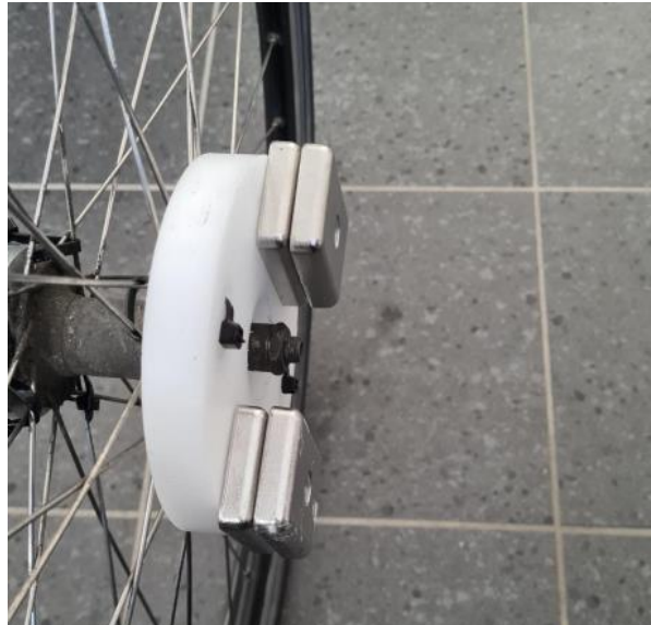
Figure 15 – Image du système d'équilibrage de la V0
