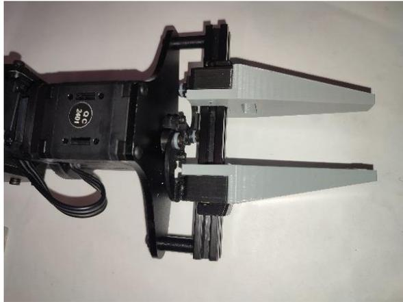
Figure 13 : Gripper de Widow avec la pince imprimée (en gris)
