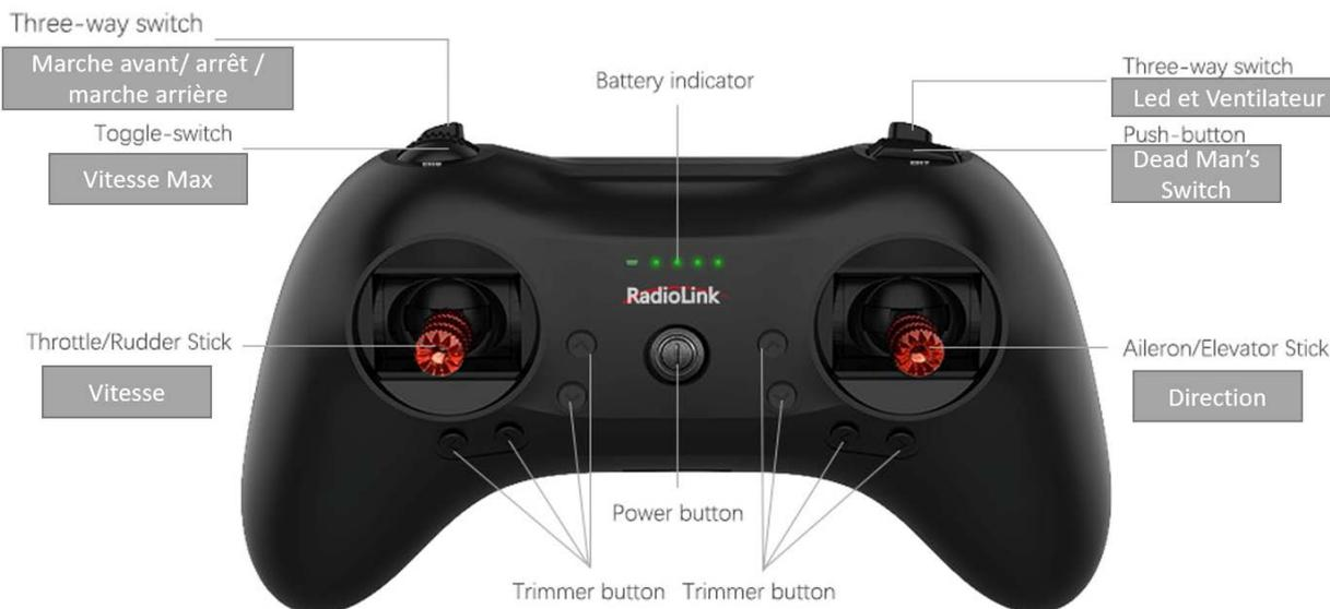
**Fig. 4.8** – La radiocommande du robot et les commandes associées
