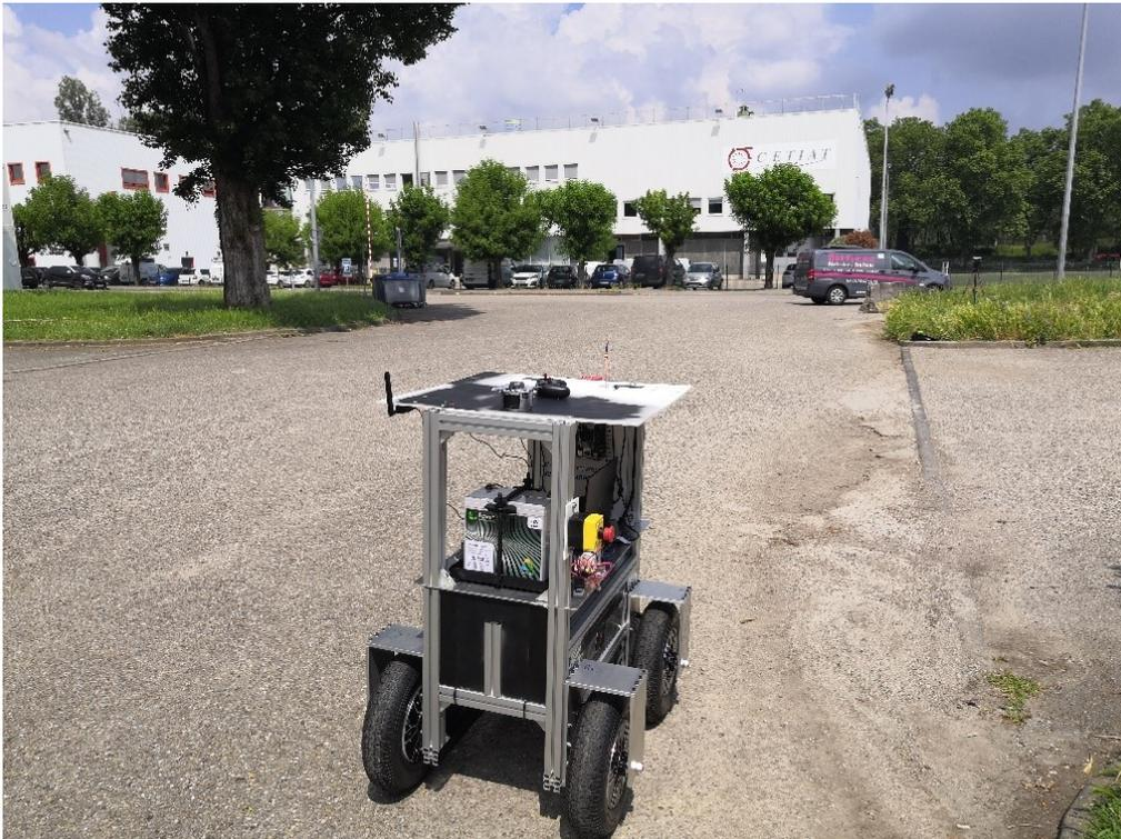
Fig. 5.7 – Essai pour le filtre de Kalman, avec un arbre qui perturbe la mesure, et la base RTK à droite
