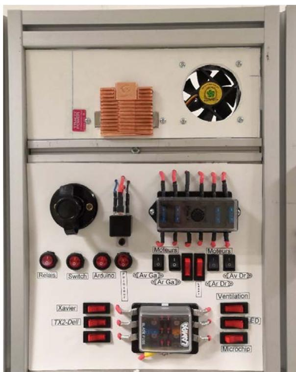
Fig. 4.7 – Panneau de contrôle du robot
