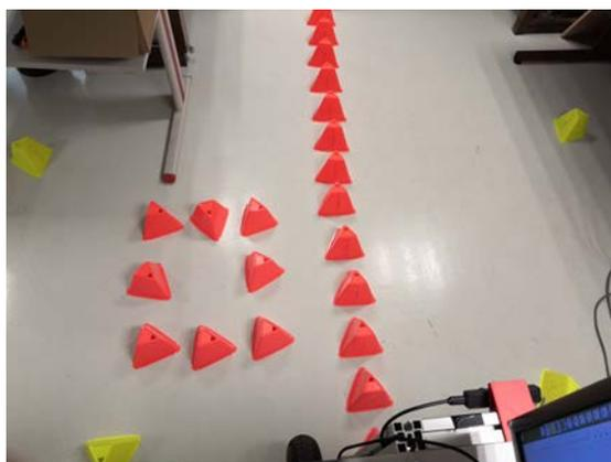
**Fig. 6.7** – Champ de vision du robot. Les plots jaunes sont à la limite de la détection de la caméra
