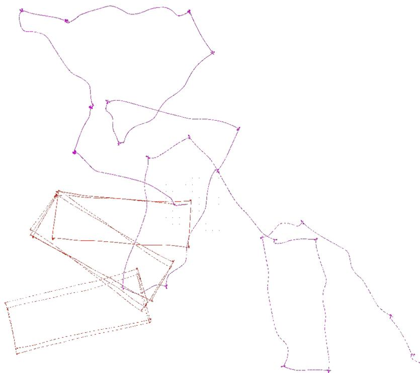
**Fig. 5.4** – Estimation de l'odométrie du robot. En violet en utilisant seulement les capteurs des roues et en rouge en combinaison avec l'IMU
