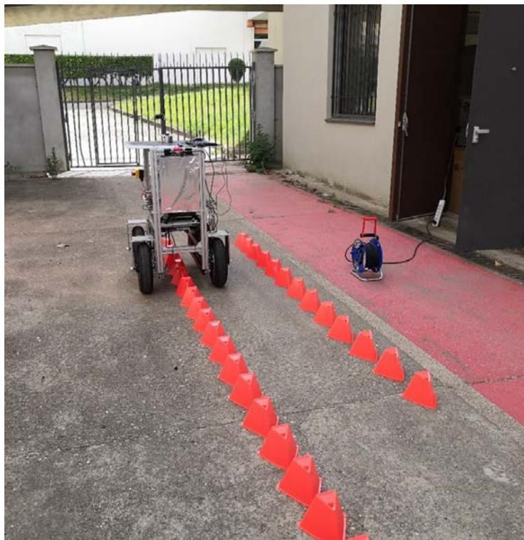
**Fig. 6.22** – Essai de déplacement du robot en mode autonome
