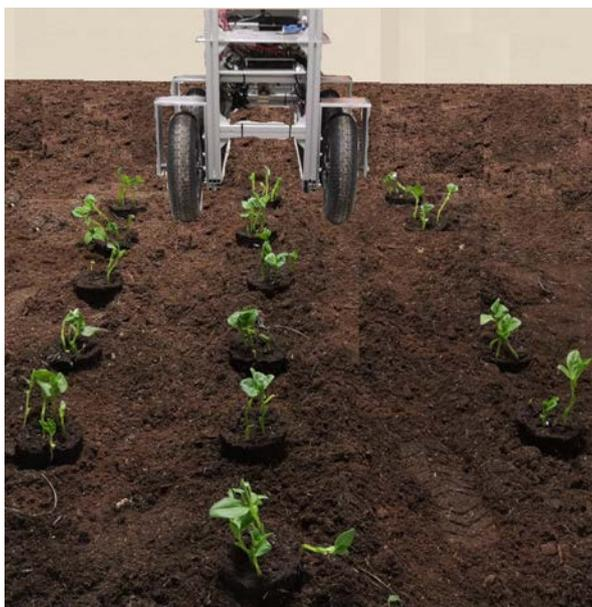
**Fig. 1.1** – Le robot se place au-dessus d'une rangée et les plantes passent dans le robot
