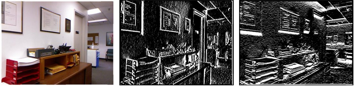
FIGURE B.1 – De gauche à droite : image originale, image après filtre de Sobel selon x, image après filtre de Sobel selon y
