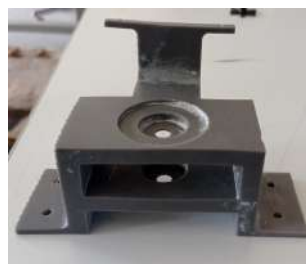
FIGURE 2.7 – pièce résine ayant certains défauts d'impression
