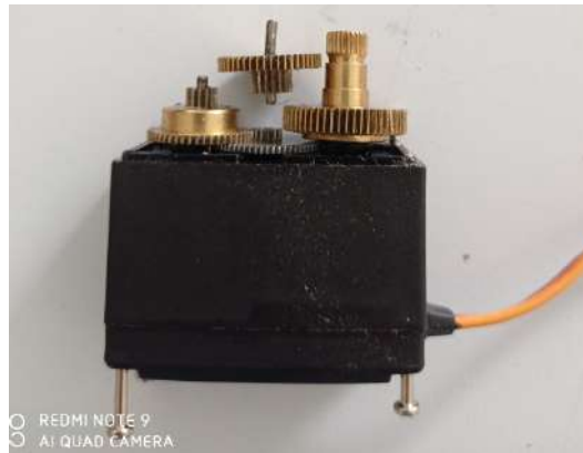
FIGURE 2.3 – Servomoteur plié après premiers essais.
