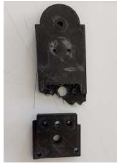
FIGURE 2.8 – Pièce FDM ayant rompu sous l'effort.
