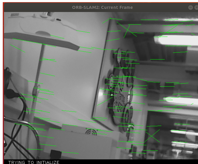
FIGURE 4.6 – Phase de matching de points dans l'algorithme d'ORB-Slam
