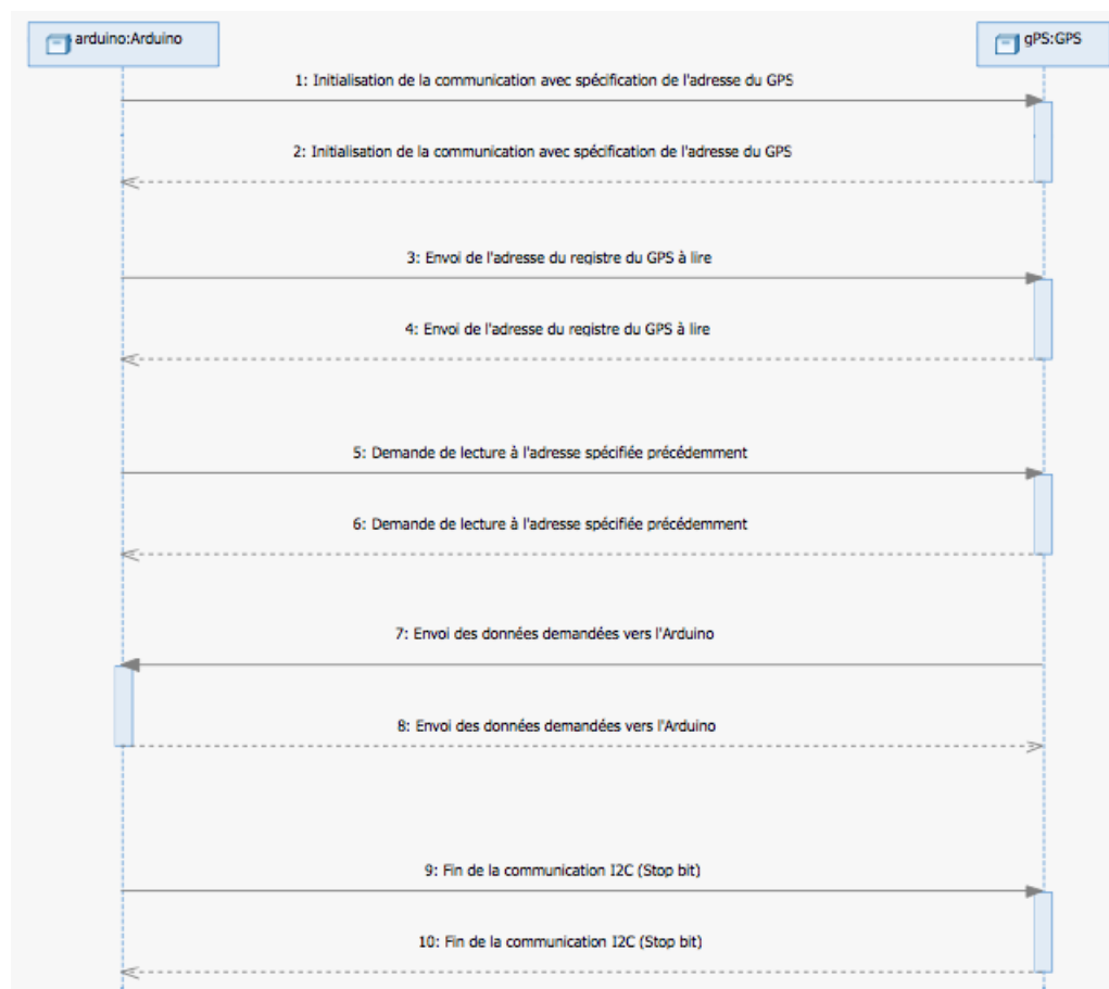
FIGURE C.2 – Diagramme de séquence de la communication I2C
