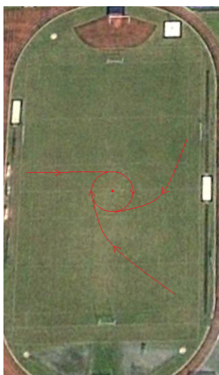
FIGURE 3.5 – Test de la régulation en cercle
