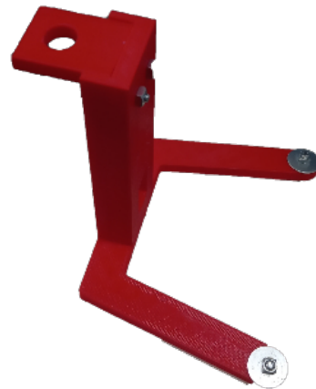
FIGURE 6 – Structure utilisée pour fixer l'anémomètre et le GNSS
