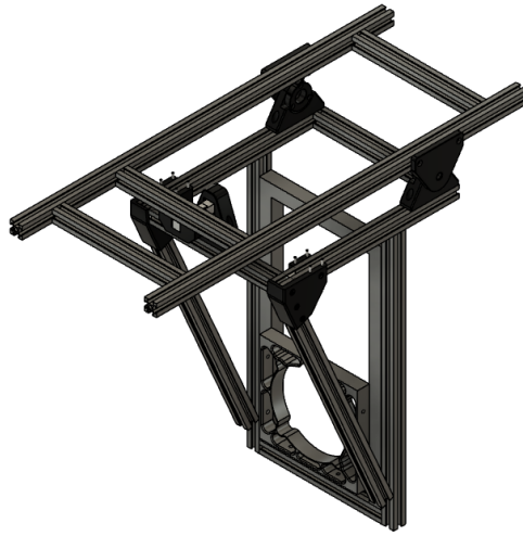
FIGURE 5 – Le banc de test pour le contrôle de performance des DiskDrive
