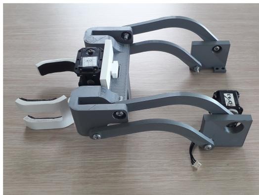
FIGURE 16 : Version du bras avec un moteur
