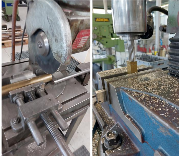
FIGURE 4 – découpe et usinage de la glissière
