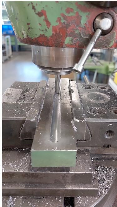
FIGURE 15 – Usinage du support de pièce
