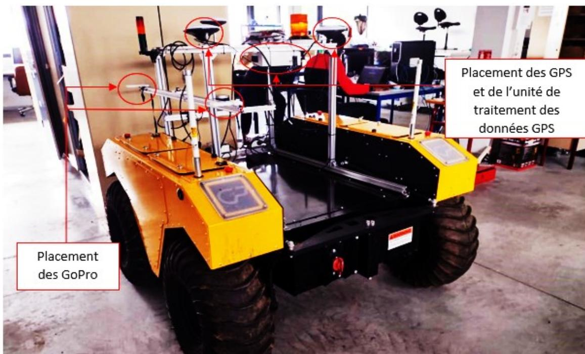
Figure 8 : Installation du matériel de photogrammétrie
