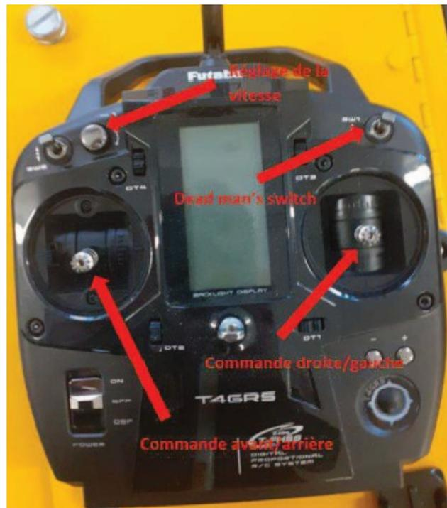
Figure 7 : Télécommande de contrôle manuel
