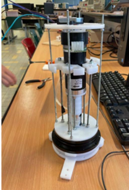
FIGURE 13 – Structure complète de l'épaule du robot
