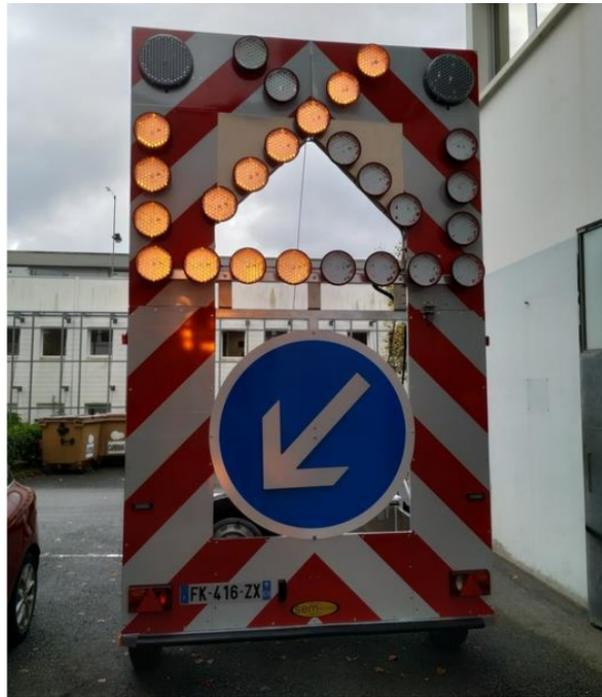
FIGURE 7.2 – Robot suiveur pour signalisation de travaux sur autoroute
