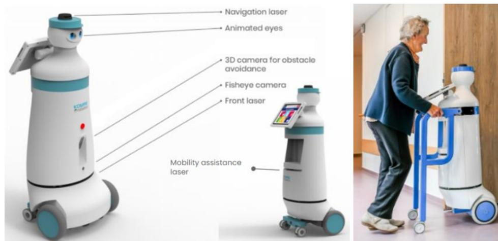
FIGURE 2.3 – Composants du robot Kompaï
