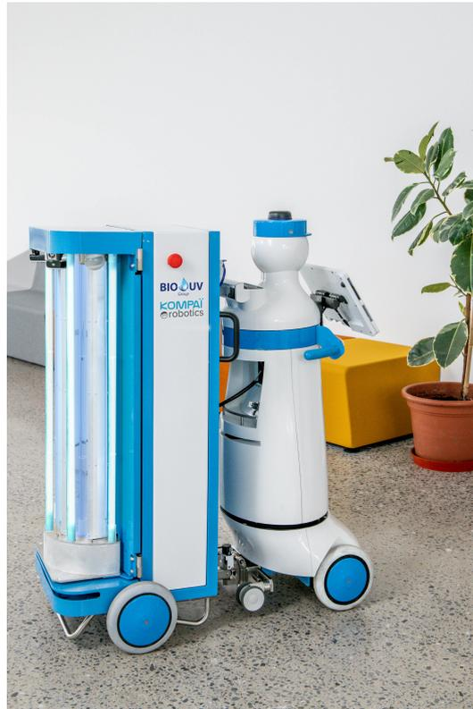
FIGURE 7.3 – Robot Kompai portant le module de désinfection Bio-UV
