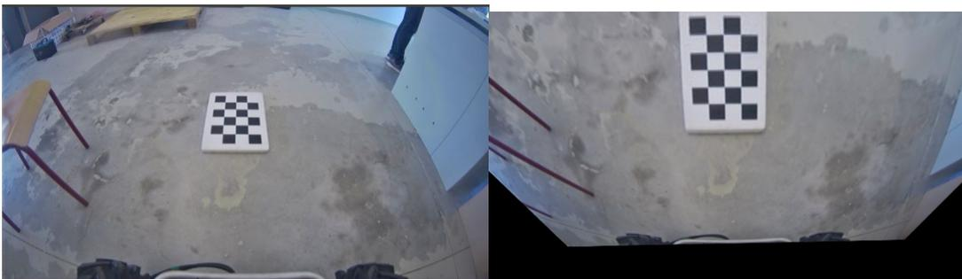
FIGURE 2.1 – image de la caméra avant traitement (à gauche) et après traitement (à droite)
