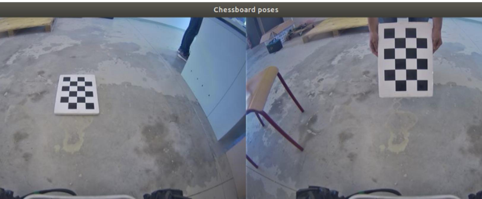
FIGURE 3.3 – Calibration de la caméra
