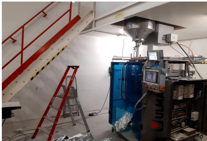
(b) Ligne de production avec ensacheuse
