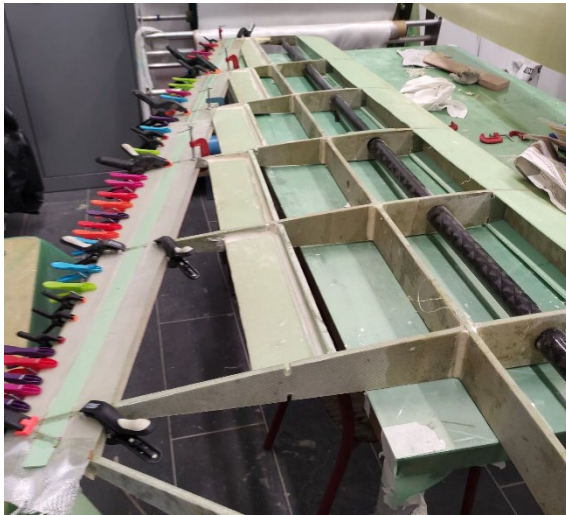
Figure 1: structure interne de l'aile
