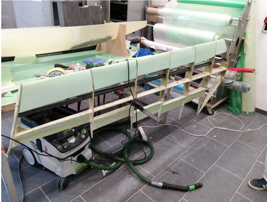
Figure 4: Thermoformage des plaques d'Airex
