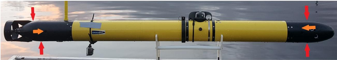
FIGURE 4 : Les pompes de déplacement suivant un plan horizontal - en orange - ou vertical - en rouge
