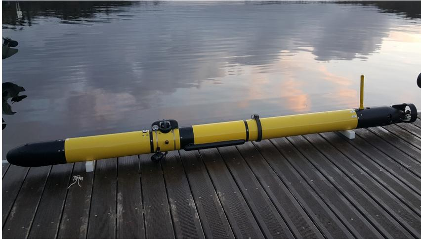
FIGURE 1 : FOLAGA équipé d'un sideScan, de la tête acoustique et d'une caméra
