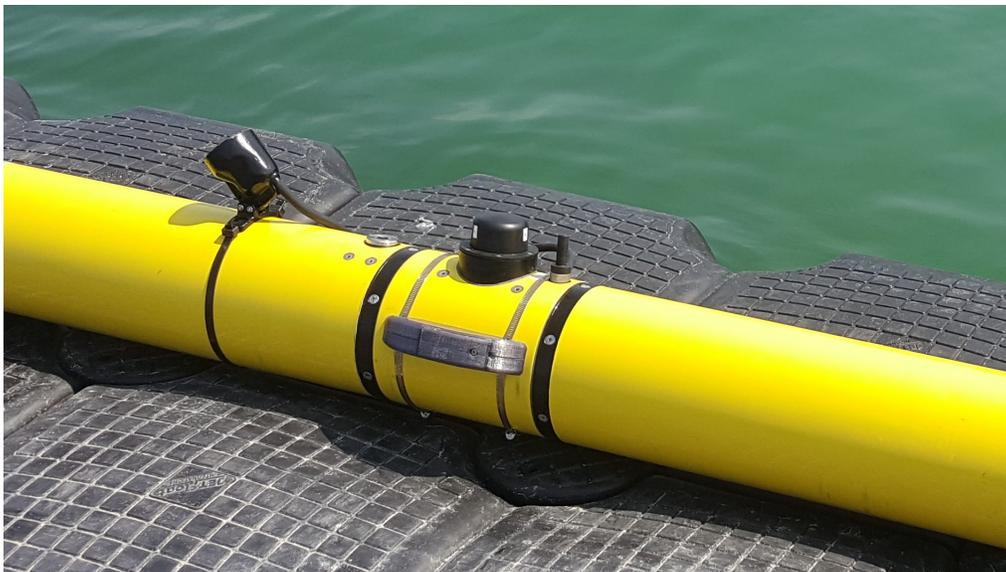
FIGURE 6 : Payload acoustique (délimitée visuellement par un changement de couleur)
