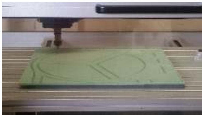
FIGURE 3.8 – Usinage d’un quart de drone dans de la mousse airex
