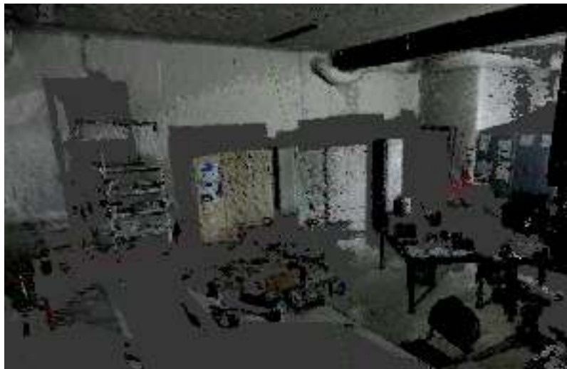
FIGURE 3.3 – Un rendu 3D avec Rtabmap, une kinect, en salle robotique, affiché sous blender.
