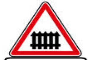
**Figure 5:** Signalisation routière des PN 2<sup>ème</sup> catégorie : automatique
