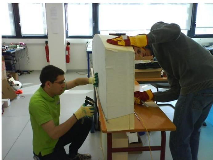
Image 5 : Découpe de la mousse au fil chaud en s'appuyant sur des tiges métalliques
