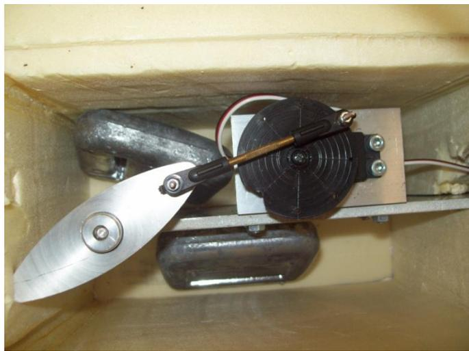
Image 11 : blocage dû à l'alignement des axes bras/palonnier
