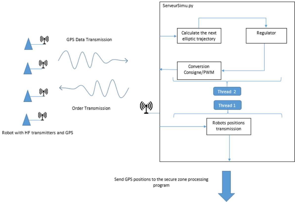
FIGURE 4.8 – Architecture mise en place pour la simulation sur robot char.
