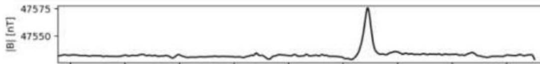
Anomalie détectée par le magnétomètre
