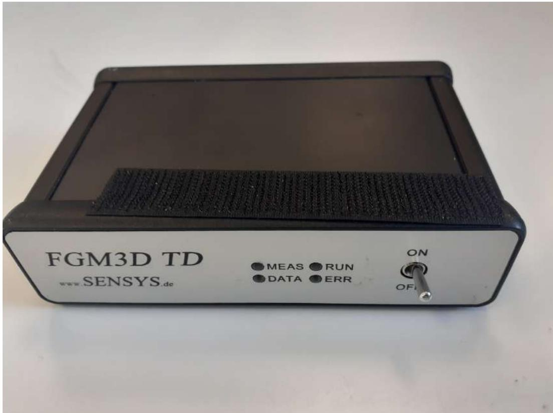
Figure 14 : Digitaliseur du magnétomètre
