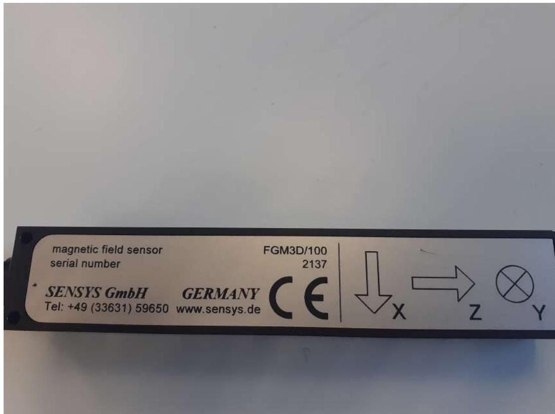
Figure 2 : Magnétomètre FGM3D/100
