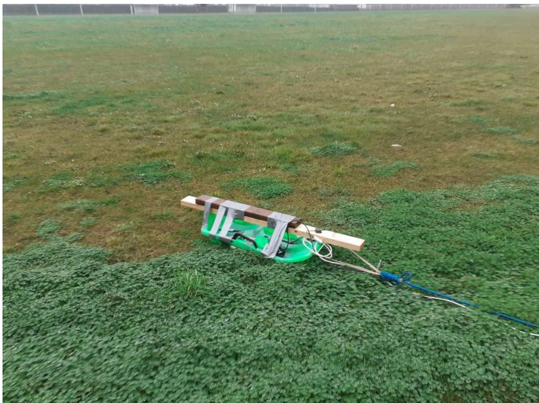
Figure 59 : La luge utilisée avec le magnétomètre, un récepteur GNSS et une pièce de bois pour alourdir la luge
