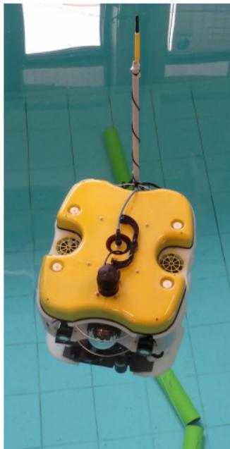
ROV/AUV Ciscrea équipé d'un caisson d'autonomie (PC compact sous Linux, Middleware MOOS pour la commande et l'enregistrement des données)
