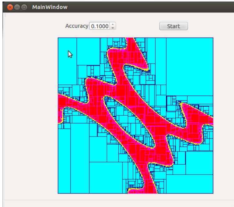
FIGURE 2 – SIVIA (2ème version). Le résultat est obtenu en alternant contraction et bisection. Le nombre de noeuds générés par l'algorithme est plus faible, 2623 , et on peut s'apercevoir que la frontière entre l'intérieur et l'extérieur est plus fine.
