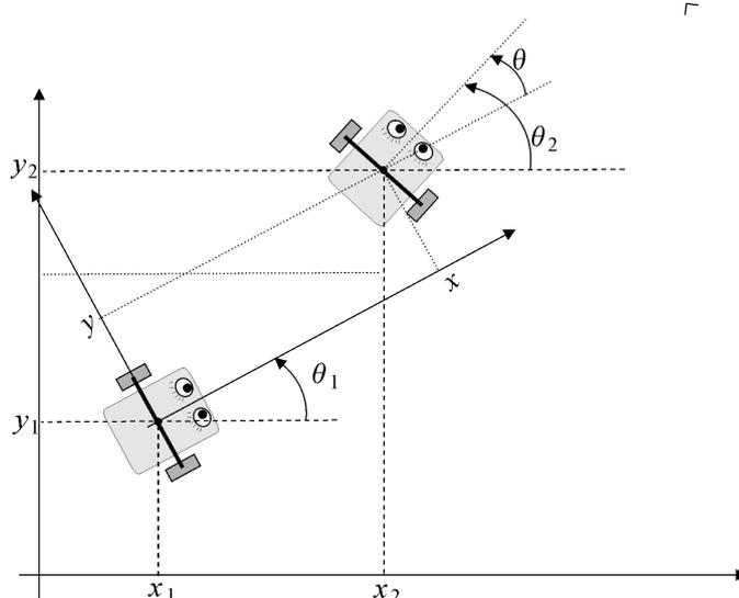
2) On suppose que les variables de commande  $v_1$  et  $v_2$  du robot 2 sont connues (un polynôme en  $t$  par exemple). Proposer un régulateur nous générant  $\mathbf{u}$  pour avoir  $x_1 = w_1$  et  $x_2 = w_2$ , où  $\mathbf{w}$  correspond à une consigne en position relative. Les pôles pour l'erreur seront fixés à  $-1$ .
