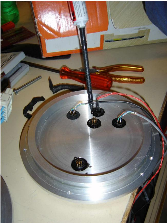
Figure 2 : montage des connecteurs de la tape avant
