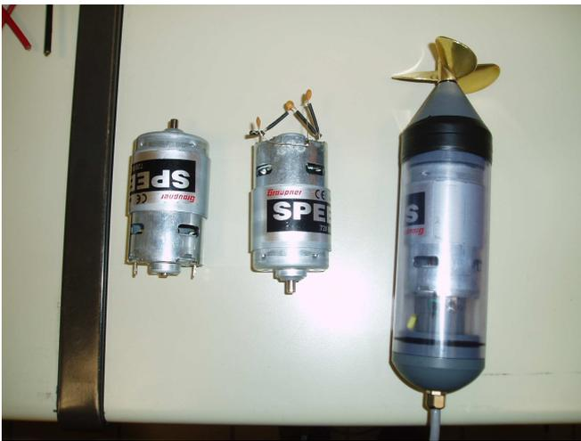
*Figure 3 : Les propulseurs et leur boîtier étanche*
