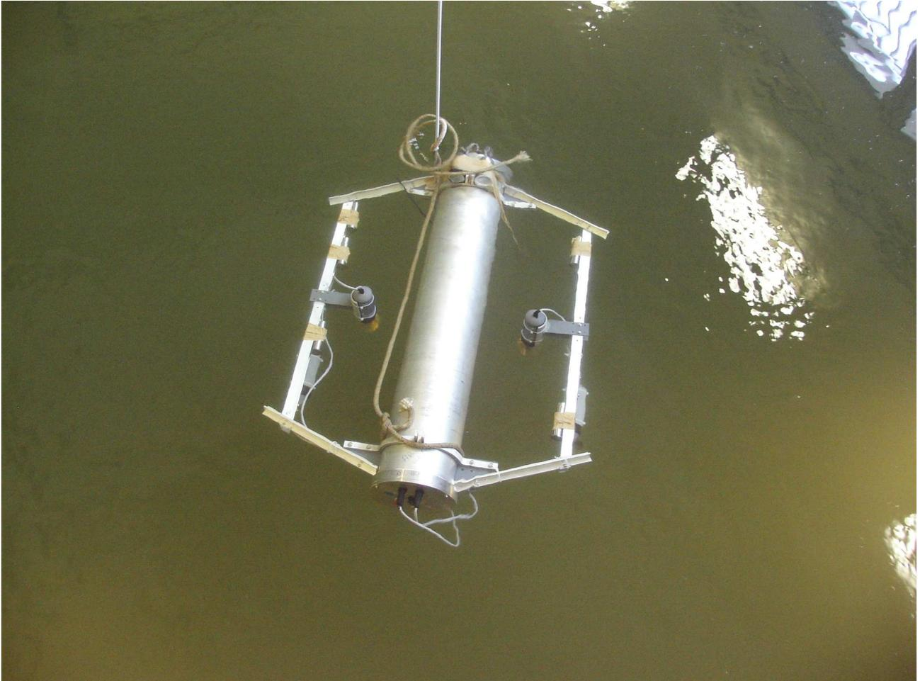
Figure 1 : le robot SOS en surface
