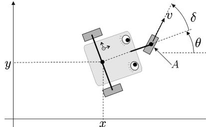
Le conducteur du tricycle possède deux commandes : l'accélération de la roue avant et la vitesse de rotation du volant. Les variables d'état de notre système sont constituées par les coordonnées de position, (les coordonnées  $x, y$  du centre de l'essieu arrière, l'orientation  $\theta$  du tricycle, et l'angle  $\delta$  de la roue avant) et la vitesse  $v$  du centre de la roue avant. L'équation d'évolution du tricycle s'écrit
