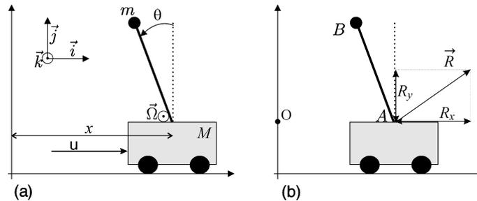
**Modèle dynamique.** La quantité  $u$  est la force exercée sur le chariot de masse  $M$ ,  $x$  indique la position du chariot,  $\theta$  est l'angle entre le pendule et la verticale. Les équations d'état s'écrivent sous la forme
