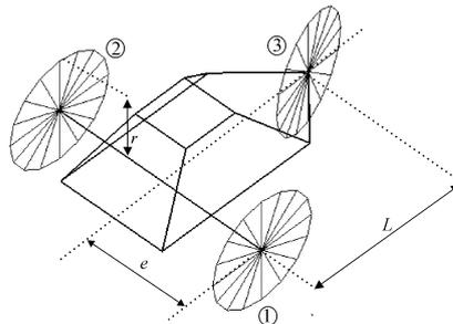
On notera  $e$  la distance entre chaque roue arrière et l'axe du tricycle. On prendra  $e = 2\text{m}$ . Le rayon des roues sera noté  $r$  et on prendra  $r = 1\text{m}$ . On rajoute pour cela trois variables d'état  $\alpha_1, \alpha_2, \alpha_3$  correspondant à la rotation propre de chaque roue (numérotées de 1 à 3 comme sur la figure). En utilisant la règle de composition des vitesses, calculer les vitesses que doivent posséder chacune des roues.
